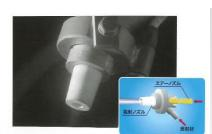
圧縮空気の力で投射材をノズルから 投射する方式です。 局部的な処理に適しています。
